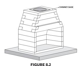
COMPLETED FIREBOX AND SMOKE CHAMBER
